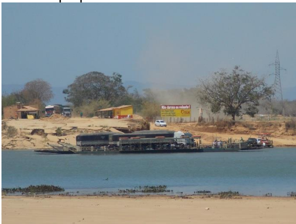
Balsa de porte grande, transportando carreta e bi-trem carregados com grãos.
