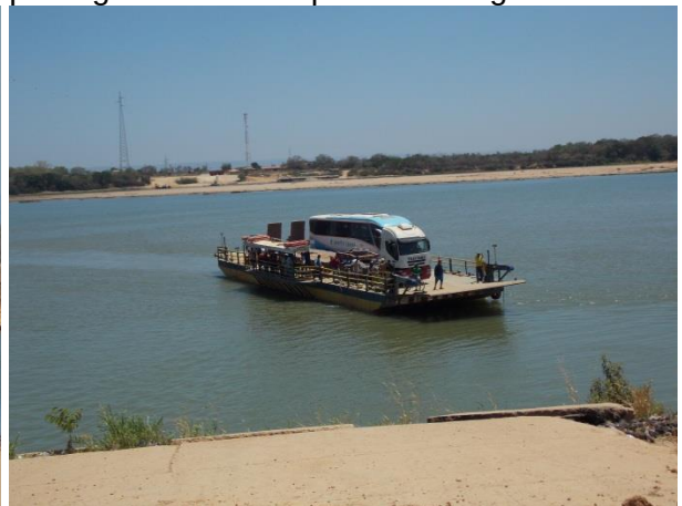
Balsa de porte grande, com capacidade para transporte de veículos de carga de grande porte, inclusive carregados.
