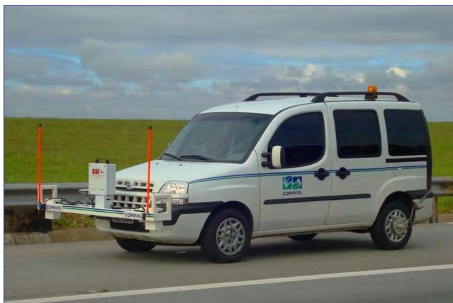
**Figura 18 – Perfilômetro a Laser**
