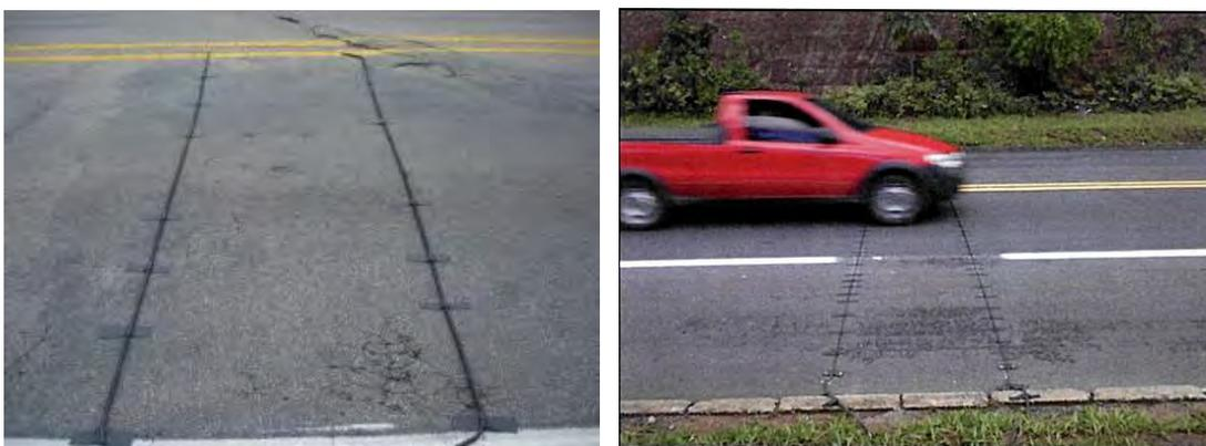
**Figura 7 – Contagens Volumétricas Classificadas Automáticas: tubos pneumáticos instalados na via**
