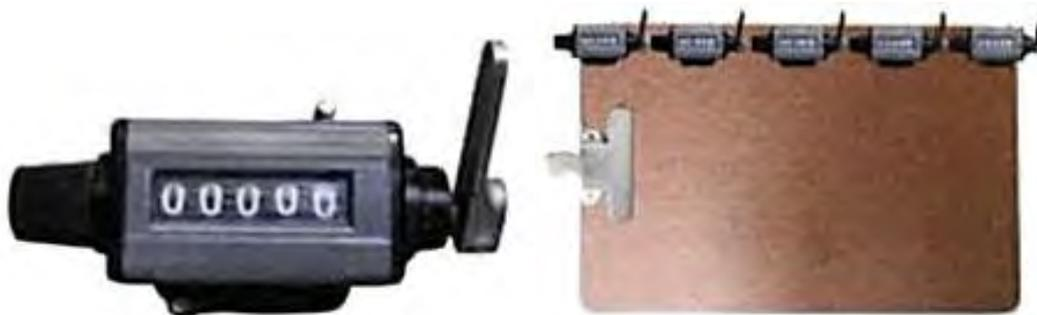
Figura 9 – Contagens Volumétricas Classificadas Manuais: contadores mecânicos e prancheta
